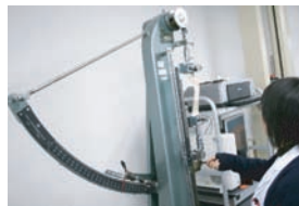
■強度試験。 織物の強度を測定しています。
