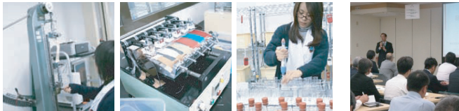
↑ 公的検査機関で当社商品の試験を実施しています。写真左から、強度試験の様子、摩擦堅牢度試験の様子、ホルムアルデヒド含有試験の様子。
