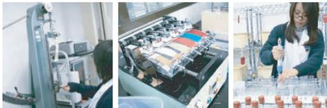
↑公的検査機関で当社オリジナル商品の試験を実施しています。写真左から、強度試験の様子、摩擦擦堅牢度試験の様子、ホルムアルデヒド含有試験の様子。
