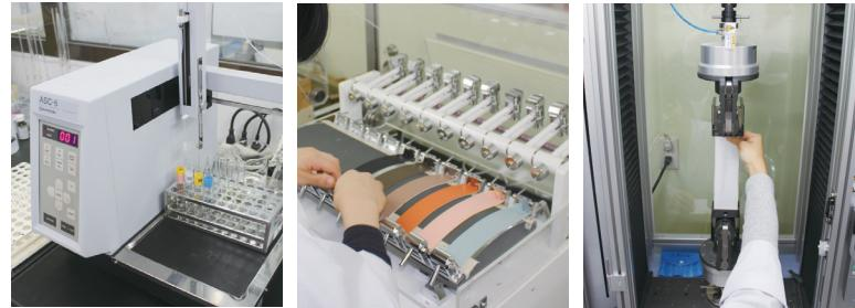
公的検査機関で当社商品の試験を実施しています。写真左から、強度試験の様子、摩擦堅牢度試験の様子、ホルムアルデヒド含有試験の様子。
